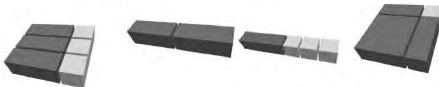
Figura 13. Exemples de col·locació correcta de peces.
